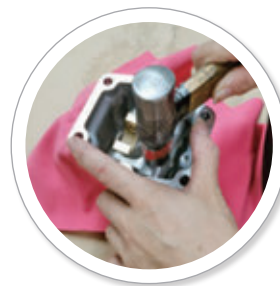
ピン打ち込み工程
