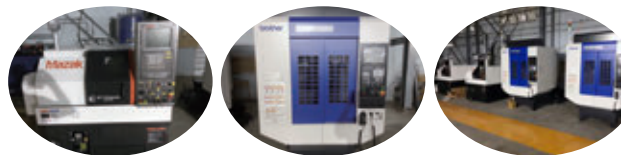
MAZAK QTP100SG NC 旋盤 2台 BROTHER S500X1 MC2 2軸の計4台 2018年8月に導入、稼働開始しております。
