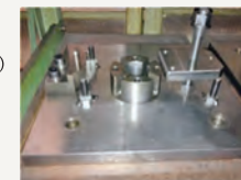
異形材位置決め治具 (写真右) 多数個取り治具 (写真下)
