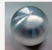
汎用立型フライス盤だけで作った2連チェーンとボール
