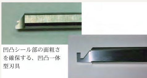
端面溝内に深溝加工する刃具
