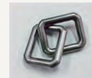
汎用立型フライス盤だけで作った2連チェーンとボール
